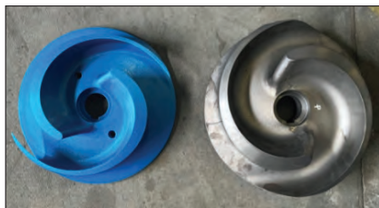
Figure 11. Impellers for experiments – left optimized, right initial Rysunek 11. Wirniki do badań – z lewej strony zoptymalizowany, z prawej strony początkowy
