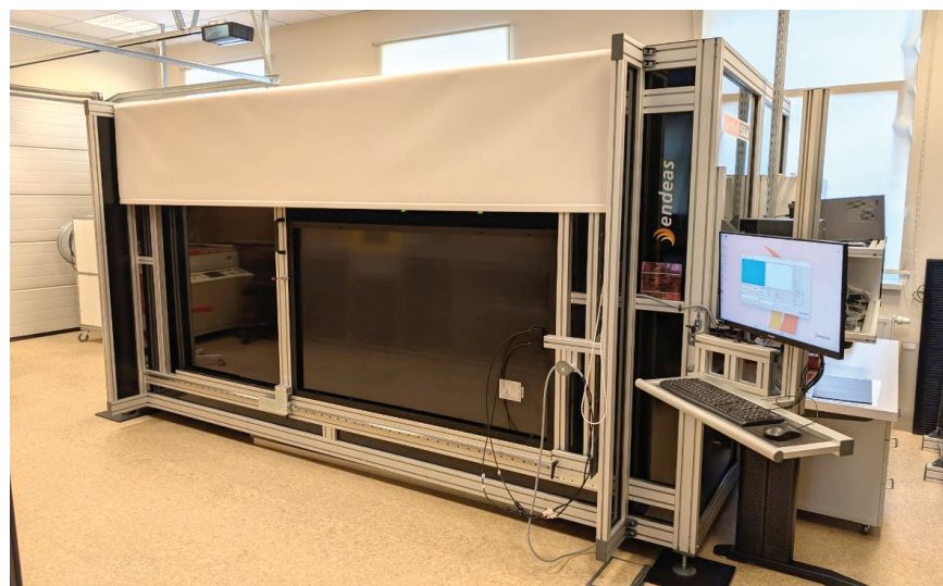
Rys. 2. Symulator światła słonecznego z systemem pomiarowym Endeas 650Lab Fig. 2. Endeas 650Lab solar simulator used for laboratory measurements
