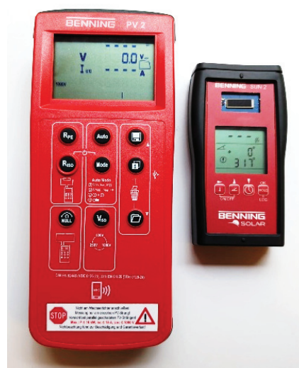
Rys. 3. Przenośny system pomiarowy Benning (PV2 i SUN2)
