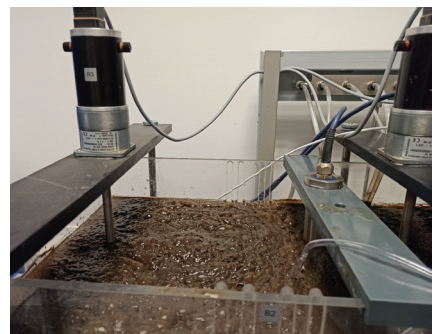
Rys. 1. Modelowy układ komory stabilizacji tlenowej Fig. 1. Model system of an aerobic stabilization chamber
