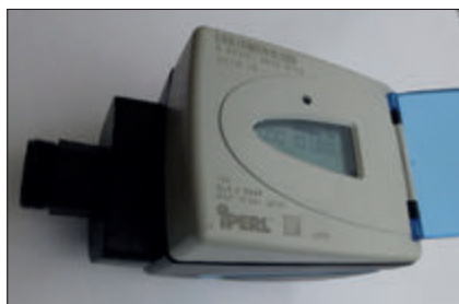
Zdjęcie 3. Wodomierz statyczny elektromagnetyczny Sensus Iperl Photo 3: Static, electromagnetic water meter (brand Sensus Iperl)
