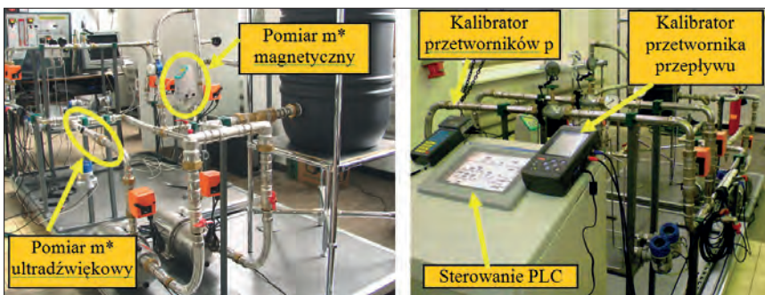
Rys. 5. Stanowisko do badań przepływowych armatury Fig. 5. Research stand for the flow armature testing
