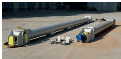
Rys. 2 Przenośniki ślimakowe w zabudowie rurowej zamkniętej
