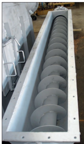
Rys. 4 Przenośnik ślimakowy w zabudowie korytowej o dużej średnicy
