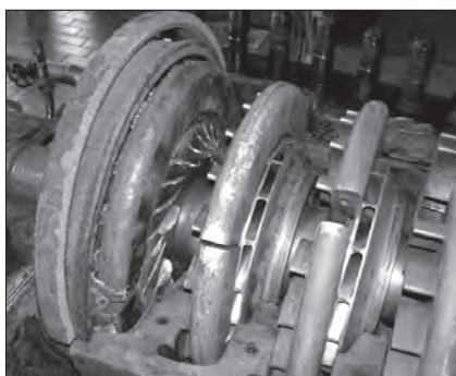
Rys. 13 Widok dolnej połówki sprężarki gazu sodowego po awarii spowodowanej pęknięciem kadłuba. (Kryłłowicz W., Klonowicz W., [3]) Fig. 13 View of the lower part of the soda-gas compressor after the casing-fracture failure [3]
