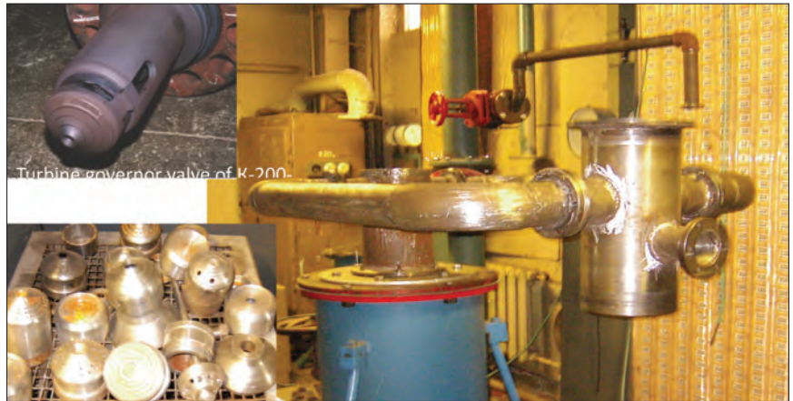
Rys. 9. Stanowisko do badań zaworów regulacyjnych Fig. 9. The stand for research of control valves
