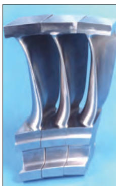
Rys. 2. Zastosowanie profilowania meridjonalnego Fig. 2. Application of meridional profiling
