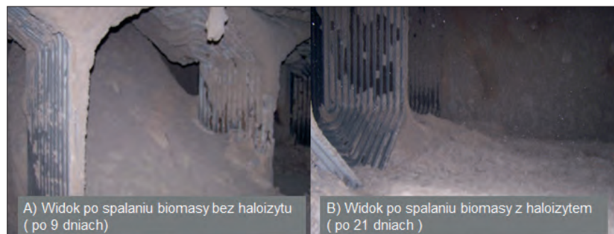
Rys. 2 Wpływ dodatku haloizytu na strukturę popiołu z przedpaleniska kotła zasilanego biomasą, wyraźnie mniejsze osiadanie popiołu na powierzchniach ogrzewalnych
