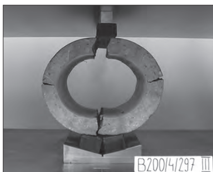
Rys. 1. Rura betonowa o średnicy 200 mm z rehabilitacyjną epoksydową powłoką CIPP bez inlinera w trakcie jej niszczenia w laboratorium Politechniki Świętokrzyskiej (zdjęcie własne) Fig. 1. Concrete pipe with a diameter of 200 mm with a rehabilitation epoxy liner CIPP without inliner during its destruction in the laboratory of the Kielce University of Technology (own photo)
