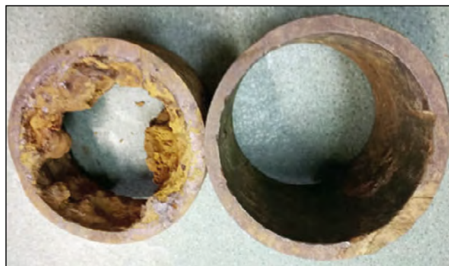
Fot. 5. Przykład efektu usunięcia osadów pod wpływem działania fosforanów Pic. 5. Example of the effect of removing sediments under phosphates action
