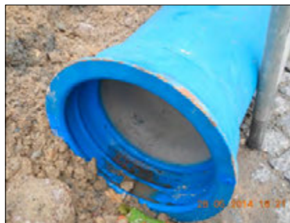
Fig. 1. Standard water pipe before using in a municipal pipeline. View from the socket Ryc. 1. Standardowa rura wodociągowa przed montażem do rurociągu miejskiego. Widok od strony kielicha
