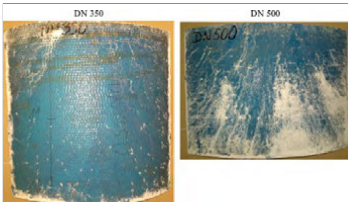
Fig. 5. The samples after 1000 hours of the salt spray test. Ryc. 5. Próbkę po 1000 godzinach testu w mgłę solnej.
