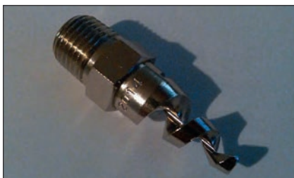
Fot.6. Dysza mgłowa spiralna DMS K3 użyta do badań
