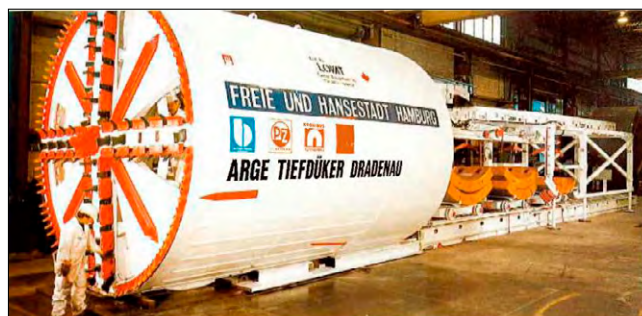
Rys. 3. Widok tarczy wykorzystanej do budowy tunelu Fig. 3. View of the drilling head used for the tunnel construction
