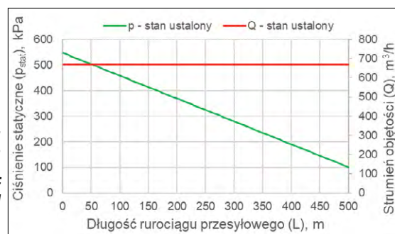
Rys. 4. Przebiegi zmian strumienia objętości ( Q ) oraz ciśnienia statycznego ( p_{stat} ) w rurociągu przesyłowym, przedstawione w funkcji długości rurociągu ( L ) dla symulacji numerycznych w stanie ustalonym
