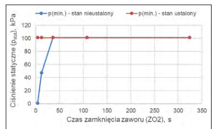
Rys. 8. Przebieg zmian wartości minimalnego ciśnienia statycznego ( p(\min.) – stan nieustalony) w rurociągu przesyłowym, przedstawiony w funkcji całkowitego czasu zamknięcia zaworu (ZO2). Dla celów porównawczych zamieszczono przebieg wartości minimalnego ciśnienia statycznego ( p(\min.) – stan ustalony), dla którego zawór (ZO2) jest cały czas otwarty.
