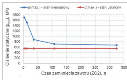
Rys. 7. Przebieg zmian wartości maksymalnego ciśnienia statycznego ( p(\max.) – stan nieustalony) w rurociągu przesyłowym, przedstawiony w funkcji całkowitego czasu zamknięcia zaworu (ZO2). Dla celów porównawczych zamieszczono przebieg zmian wartości maksymalnego ciśnienia statycznego ( p(\max.) – stan ustalony), dla którego zawór (ZO2) jest cały czas otwarty.
