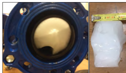
Rys. 7. Widok korka lodowego po zakończeniu eksperymentu. Po lewej po zdjęciu kołnierza zaślepiającego rurę badawczą, po prawej po wyjęciu na zewnątrz Fig. 7. View of the ice plug after the end of the experiment. On the left, after removing the flange covering the test pipe, on the right, after taking it out
