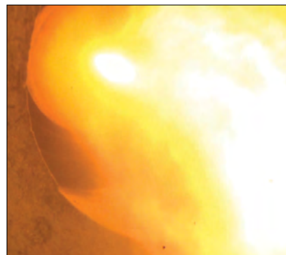
Rys. 14 Fazy rozruchu palnika pyłowego przy zapłonie plazmowym, od góry: sam palnik plazmowy; początek podawania pyłu; zapłon pyłomieszanki
