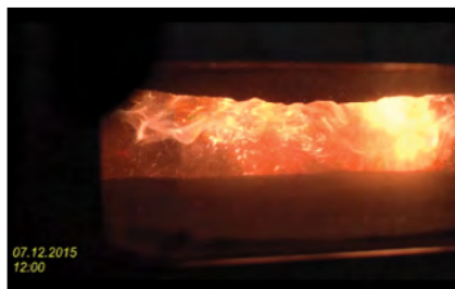
Rys. 6 Sekwencja zdjęć przedstawiająca zimny start palnika biomasowego z zastosowaniem plazmotronu
