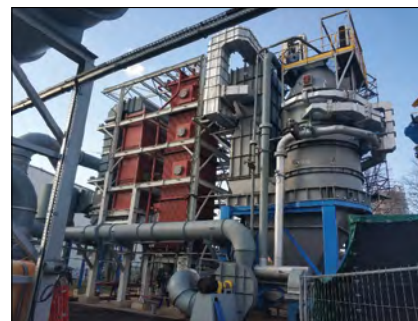
Rys. 11 Komora paleniskowa w budowie (u góry) i kocioł hybrydowy gotowy do testów (na dole)
