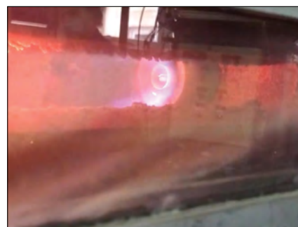
Rys. 8 Test palnika 100kW do współspalania metanu i wodoru – widok od czoła płomienia
