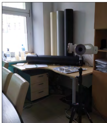
Rysunek 3. Zdjęcie obrazujące ustawienie próbnika SAS Super 180™
