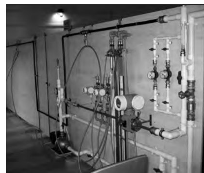
Rys. 3. Fotografia stanowiska badawczo-pomiarowego z układem kolan systemu APEX DN20
