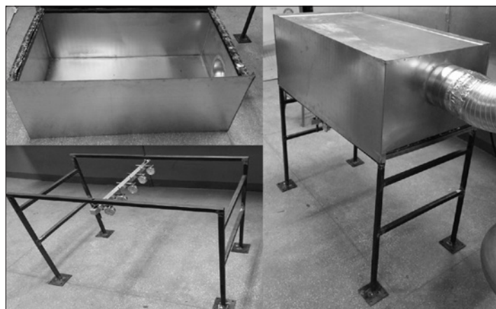
Rys. 5. Konstrukcja wsporcza, puszka rozprężna i stanowisko badawcze po zmontowaniu Fig. 5. Support structure, plenum box and test stand after assembly
