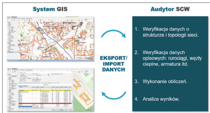
Rys. 3 Schemat wymiany danych pomiędzy programem Audytor SCW i systemem GIS Fig. 3 Data flow diagram between the Auditor SCW program and the GIS system
