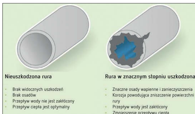
Rysunek 4. Wpływ osadzania się zanieczyszczeń w rurach poziomych – rurociąg czysty i zabrudzony [na podstawie 33, 39] Figure 4. Effects of dirt deposits in horizontal pipes – clean and dirty pipeline [on based 33, 39]
