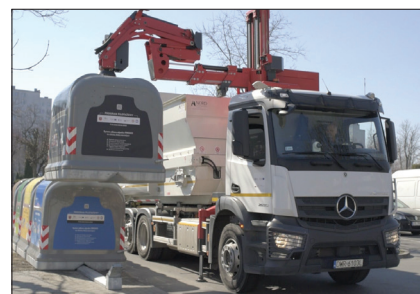
Zdjęcie 1. Sposób opróżniania pojemników w systemie PRESKO
