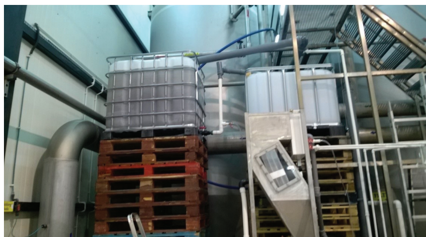
Rys. 3. Instalacja badawcza: widoczne dwie komory reakcji (komora nr 1) wypełniona wodą napowietrzoną (komora nr 2) pusta Fig. 3. Research installation: two reaction chambers visible (chamber no. 1) filled with aerated water (chamber no. 2) empty
