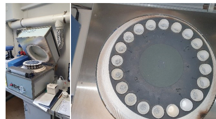
Rys. 2. Badania laboratoryjne odgazowania zanieczyszczeń organicznych z pyłu i wiórów aluminium
