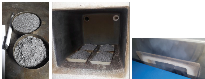
Rys. 1. Próbkę materiału surowego, próbki umieszczone w komorze pieca laboratoryjnego oraz widoczne zadymienie komory pieca w temperaturze 300 °C
