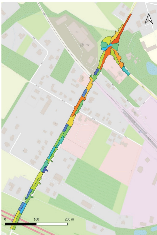
Rys. 6. Mikrozwlewnie przypisane do poszczególnych wpustów ulicznych dla zakresu nr 1 Fig. 6. Micro-catchments assigned to individual street inlets for range no. 1
