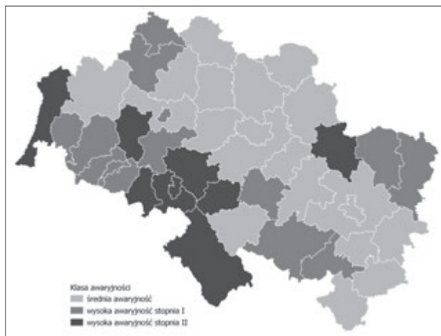
Rys. 5. Klasyfikacja powiatów ze względu na maksymalną wartość z maksymalnych wartości wskaźnika intensywności uszkodzeń sieci wodociągowej w jednostkach administracyjnych Fig. 5. Classification of poviats due to the maximum value of the maximum value of the water network failure rate in administrative units
