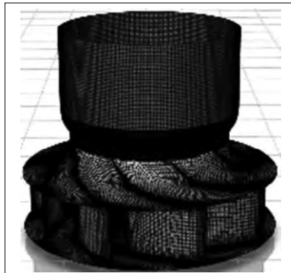
Rys. 7 Siatka wirnika wentylatora z kolektorem ssawnym LAVA 001
