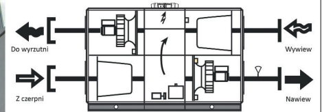
Rys. 5 Miejsce podwieszenia central wentylacyjnych wewnątrz budynku pod stropem nadbudówki, nad klatką schodową wraz ze schematem przykładowej centrali wentylacyjnej [12]
