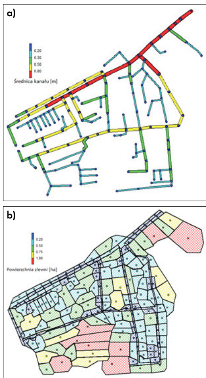
Rys. 10. Schemat sieci: a) przebieg kanałów; b) podział na zlewnie cząstkowe Fig. 10. Stormwater sewage system diagram: a) canal course; b) division into subcatchments
