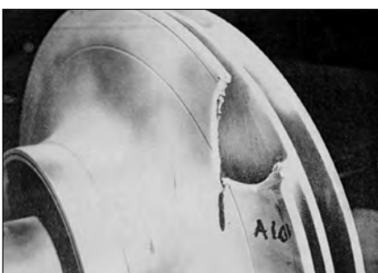
Rys. 5 Postać drgań tarczy kołowej z dwoma węzłami promieniowymi Fig. 5 The vibration mode of a circular disc with two radial nodes Rys. 6 Uszkodzenie tarczy wirnika na skutek zmęczenia materiału [1] Fig. 6 Impeller disc failure due to fatigue [1]
