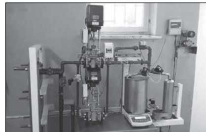
Rys. 3. Stanowisko pomiaru strumienia masy wody Fig. 3. Water mass flow measurement station
