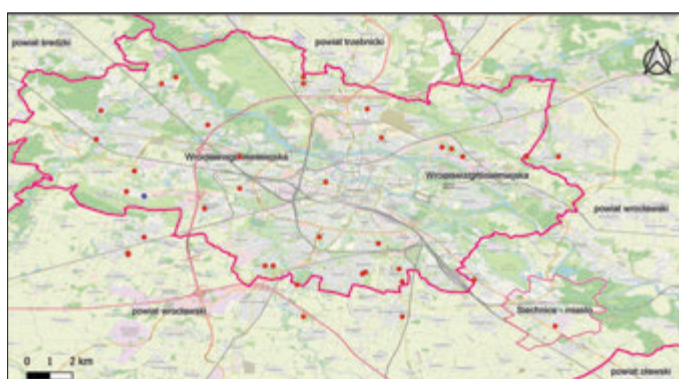
Rys. 2. Rozmieszczenie deszczomierzy na mapie Wrocławia: punkty czerwone – 36 stacji PWS, punkt niebieski – stacja IMGW-PIB Fig. 2. Distribution of rain gauges on the map of Wrocław: red points – 36 stations PWS, blue point – station IMGW-PIB
