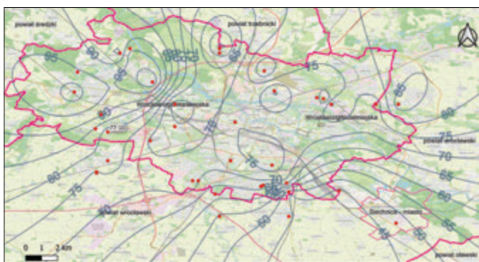
Rys. 5. Wyniki symulacji czasowo-przestrzennej wysokości opadu z dnia 2 sierpnia 2024 nałożone na mapę Wrocławia – QGIS
