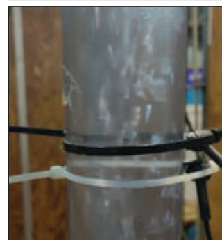
Rys. 7. Schemat stanowiska pomiarowego wraz z przykładowymi pozycjami czujników ultradźwiękowych w przewodzie poziomym i pionowym: 1 – czujniki ultradźwiękowe zainstalowane na przewodzie górnym, 2 – defektoskop ultradźwiękowy, 3 – komputer do zbierania danych pomiarowych Fig. 7. Schematic of the measurement stand with exemplary positions of ultrasonic sensors in horizontal and vertical pipes: 1 – ultrasonic sensors installed on the upper pipe, 2 – ultrasonic flaw detector, 3 – computer for collecting measurement data
