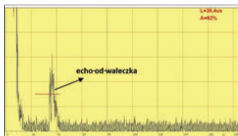
Rys. 5. Zdjęcie stanowiska do pomiaru odległości waleczka stalowego umieszczonego w wodzie od czujnika ultradźwiękowego wraz z przykładowym echogramem [17] Fig. 5. Photo of the test stand for measuring the distance of a steel roller placed in water from an ultrasonic sensor, along with an example echogram [17]
