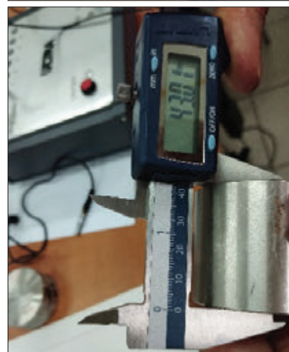
Rys. 3. Zdjęcia układu testującego wraz z pomiarem wysokości wałka suwmiarką [17] Fig. 3. Images of the test setup with roller height measurement using a caliper [17]
