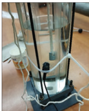
Rys. 5. Zdjęcie stanowiska do pomiaru odległości waleczka stalowego umieszczonego w wodzie od czujnika ultradźwiękowego wraz z przykładowym echogramem [17] Fig. 5. Photo of the test stand for measuring the distance of a steel roller placed in water from an ultrasonic sensor, along with an example echogram [17]
