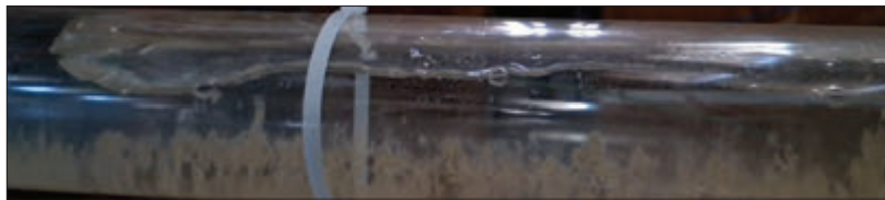
Rys. 10. Przepływ rzutowy w przewodzie poziomym Fig. 10. Slug flow in a horizontal pipe
