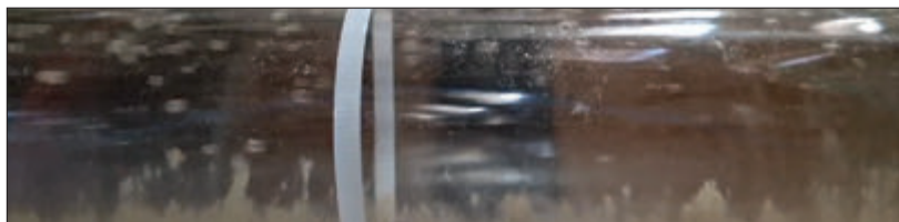
Rys. 9. Przepływ pęcherzykowy w przewodzie poziomym Fig. 9. Bubbly flow in a horizontal pipe
