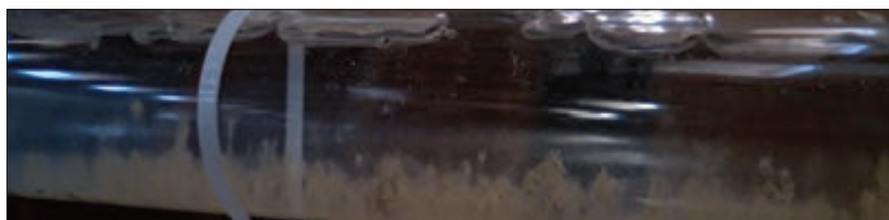
Rys. 11. Przepływ korkowy w przewodzie poziomym Fig. 11. Slug flow in a horizontal pipe
