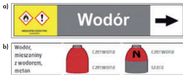
Rys. 3a. Oznakowanie rurociągu z przepływającym wodorem, Rys. 3b. Prawidłowy wygląd butli z wodorem [55]
